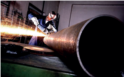
Bild 1. Konventionelle Bearbeitung eines Rohres mit einem Winkelschleifer.
